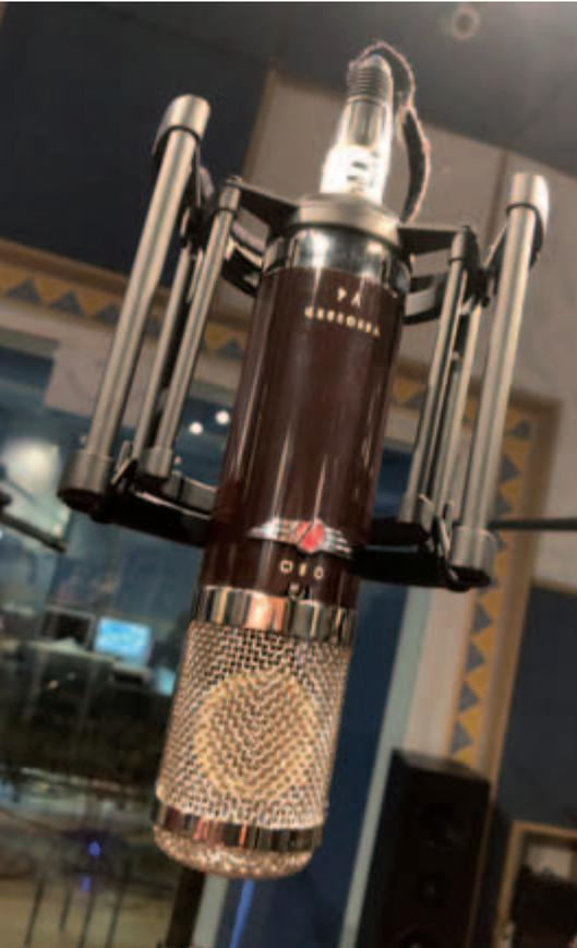
sätzlich befinden sich am Gehäuse eine schaltbare -10-dB-Dämpfung und ebenso schaltbares Trittschallfilter bei 100 Hz. Zum Lieferumfang gehören ein Transportkoffer und eine elastische Halterung, an der das Mikrofon mit einem Schraubring befestigt werden kann. Im Shop des Ver-
